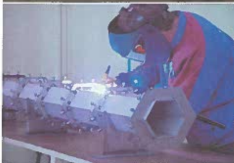
Obr. 4 Stehovanie šesťhrannej rúry pomocou objímkov metódou TIG
