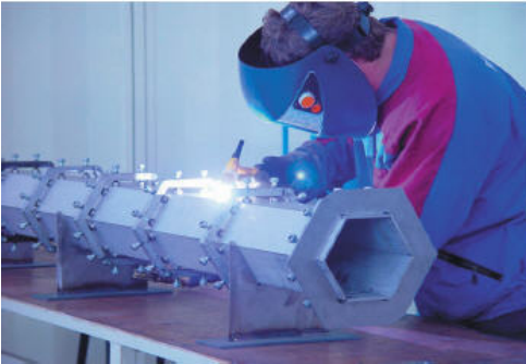
Obr. 4 Stehovanie šesťhrannej rúry pomocou objímok metódou TIG
