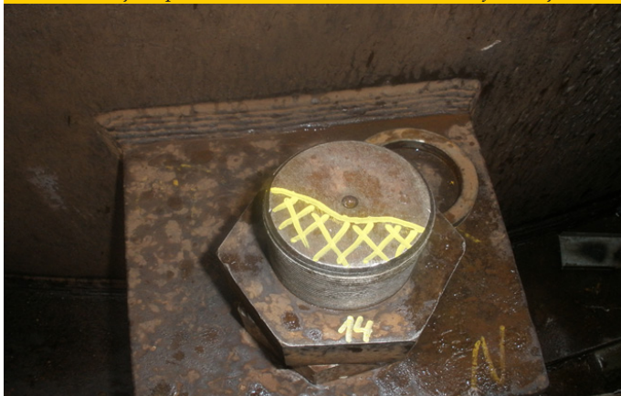
obr. 5 Ultrazvuková kontrola kotviacej skrutky – žltá šrafovaná časť je popraskaná
