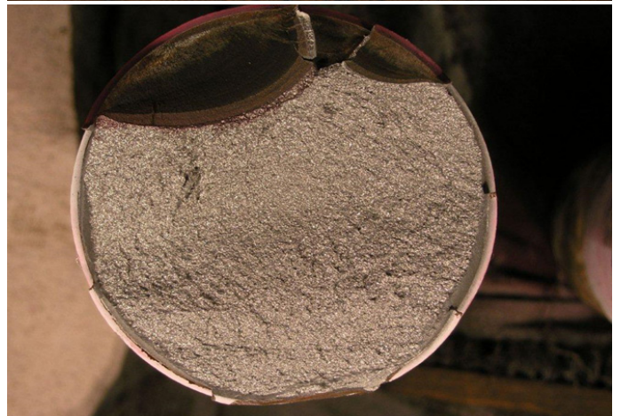
obr. 7 Únavový lom na kotviacich skrutkách
