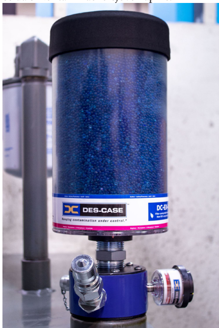
Obr. 3 Nástavec na nádrž s rychlospojkou včetně zavzdušňovacího filtru a ventilu na odběr vzorku
