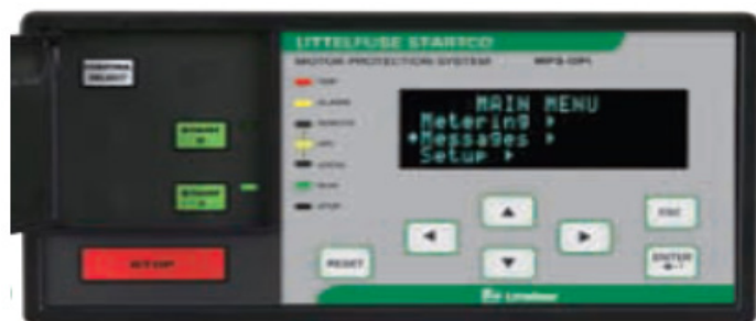
Obr.2 Ukážky komplexných systémov na ochranu elektromotorov
