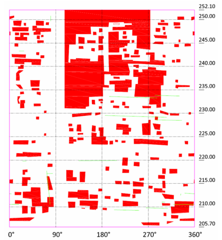
Obr. 6 Výsledok geodetického zamerania jednotlivých defektov
