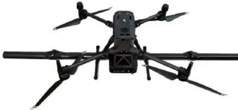
Obr. 1 Sonda lokalizátora na drone DJI M300
