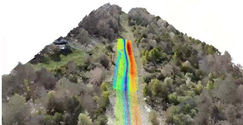
Obr. 4 Príklad zataženia potrubia na zosuvnom území
