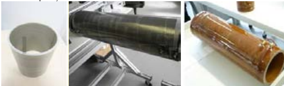
Obr. 4: Prototypy potrubí z GFR spojených s nerezovou tkaninou, laserom dierovanou kovovou fóliou a nakoniec s vláknami z uhlíkových vlákien
