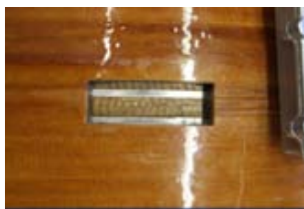
Obr. 5: Kontaktné elektródy na monitorovanie priestoru medzi dvoma kruhovými tesneniami zámkového spoja (vonkajšia stena potrubia z GRP bola čiastočne otvorená za účelom demonstrácie)
