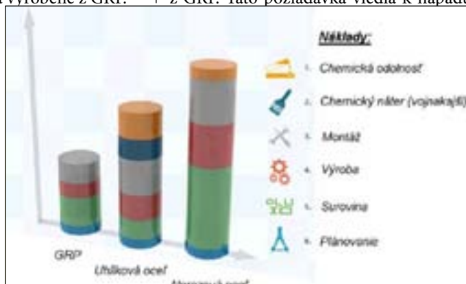
Obr.2: Náklady životného cyklu potrubí z ocele, nerezovej ocele a GRP [2]
