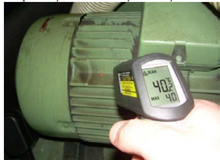
Obr. 1: Ukážka merania bezkontaktným teplomerom
