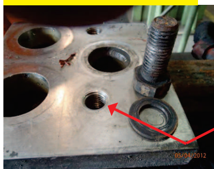
Obr. 2 Skúška chladiaceho okruhu - únik vody na chladiacom okruhu rámu bočnej stienky.
