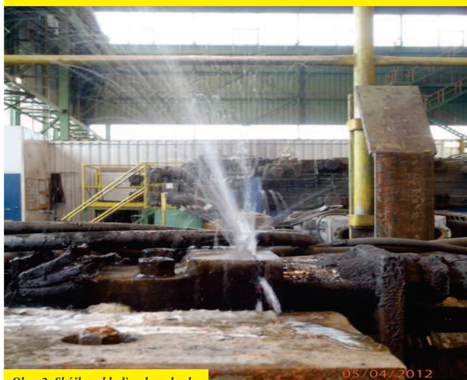
Obr. 2 Skúška chladiaceho okruhu - únik vody na chladiacom okruhu rámu bočnej stienky.
