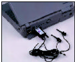
Obr. 1 Pripojenie prístrojov cez HART modem
