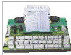
Obr. 4 Multiplexér pre pripojenie prevádzkových prístrojov
