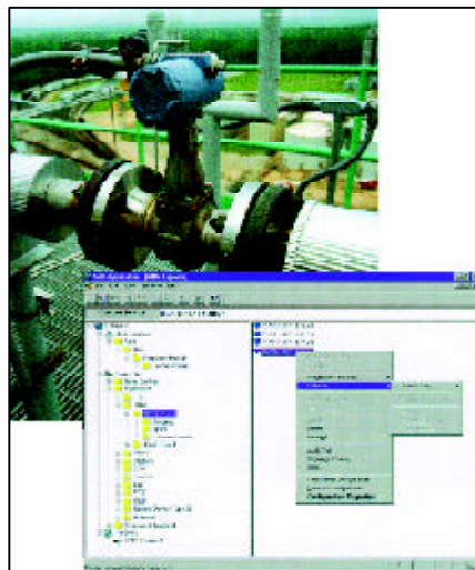
Obr. 5 Využitie Valve Link na údržbu ventilov
