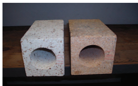
obr. 2 Meracia sonda vyhotovená z keramiky ALKO60A
