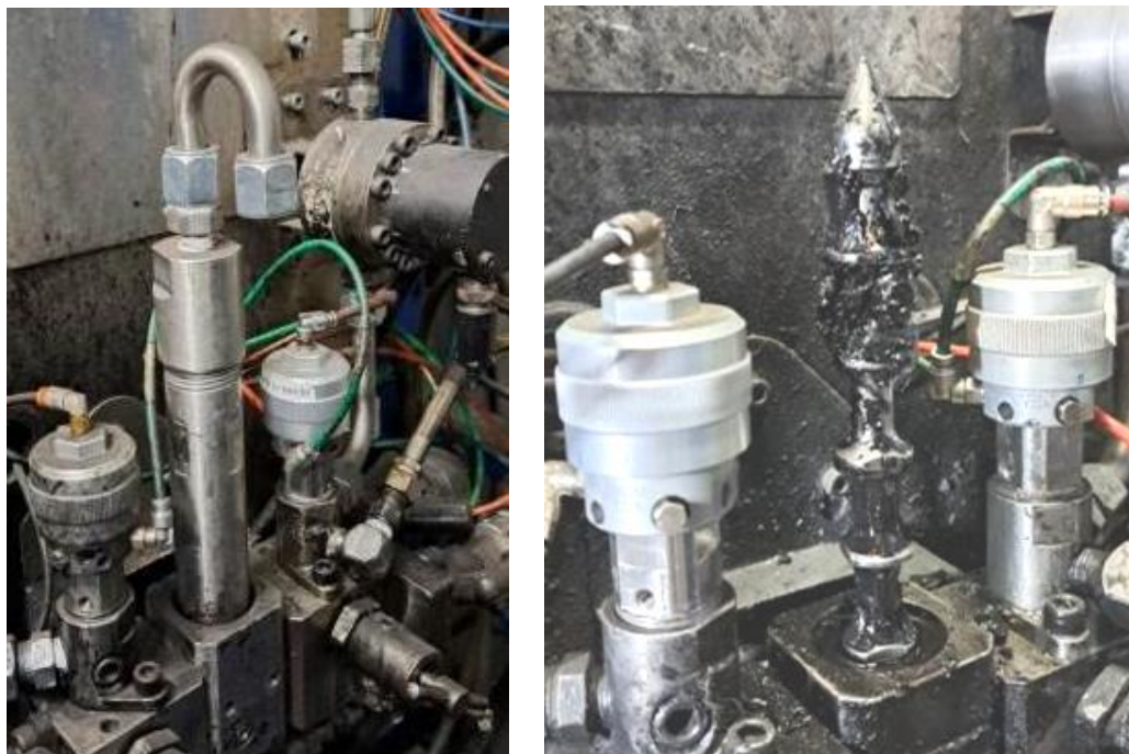
Obr. 3 Autonómna údržba PROMIXu 1 a 2, čistenie integrátora a zmiešavača
