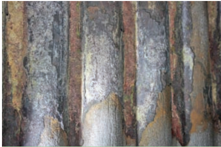
Obr. 1 Korózia spôsobená chlóróm
