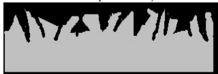
Povrch podkladu po otryskaní (ideálny pre mechanické spojenie- ukotvenie)
