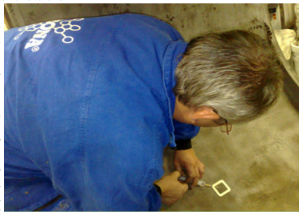
Odber meracej tekutiny z elastickej kapsuly prilepenej na meraný povrch
