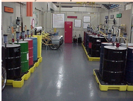
Obr. 4 Nevhodný skladování olejů – olej není nijak chráněn proti kontaminaci
