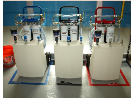
Obr. 8 Každá barva filtračního vozíku znamená jiný druh oleje - prostor pro chybu je menší
