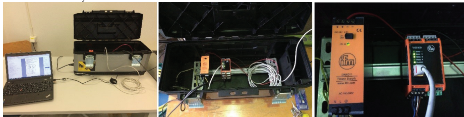
Obr. 2 Schéma možného zapojenia systému IFM efactor Octavis [6]
