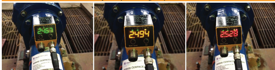
Obr. 7 Tri prípady zobrazenia aktuálnej hodnoty rýchlosti vibrácií
