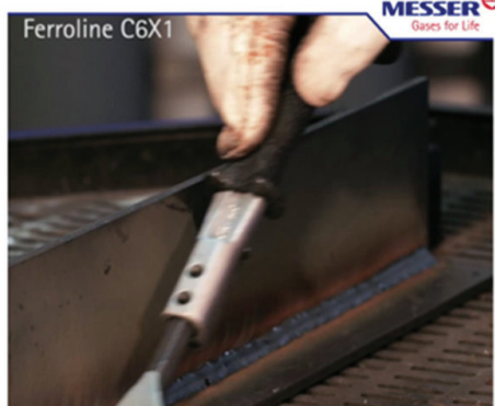
Obr. 3 Rozstrek – porovnanie Ferroline C18 a Ferroline C6X1
