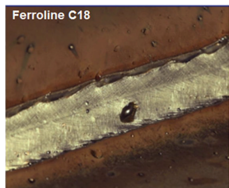
Obr. 2 Kresba zvaru – porovnanie Ferroline C18 a Ferroline C6X1
