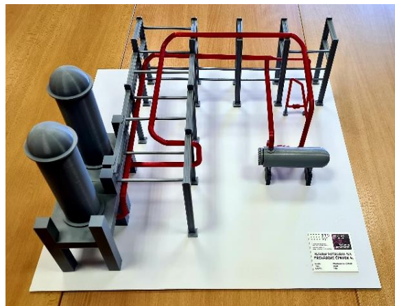
Obr. 21: 3D model v mierke 1:50 zhotovený 3D tlačou [1]
