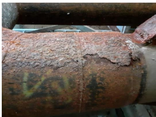
Obr. 12 Veľmi skorodované časti, ktoré nie je možné očistiť
