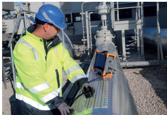
Obr. 3 Ručná sonda (PECA™, PEC) s vyššími presnosťami (Hi-Res) na prípadné domeranie zistených indikácií
