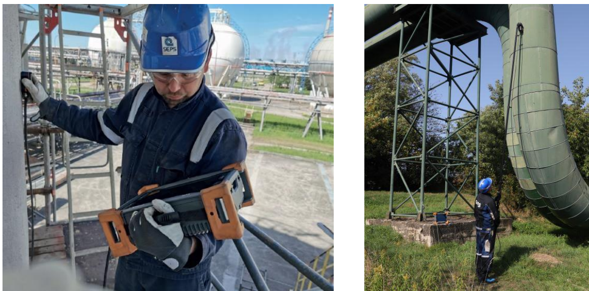
Obr. 9 Meranie hrúbky steny pod izoláciou
