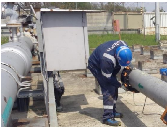
Obr. 10 Meranie priamo na stene potrubia
