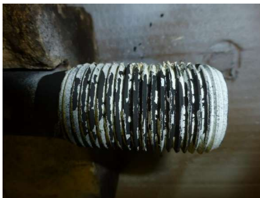
Obr. 12 Mazací pasta po teplotě 600 °C
