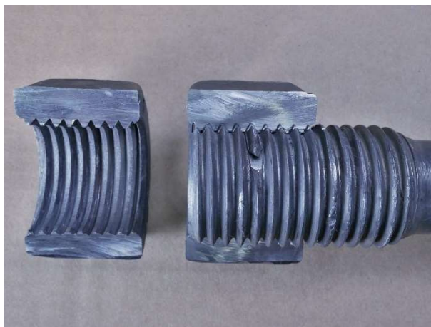
Obr. 13 Zadřený šroub (mazaný pastou, teplota kolem 600 °C)
