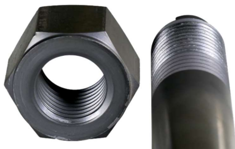
Obr. 16 Kluzný lak (Power® torque LF kote 450) se po opakovaném utažení zaleštuje.
