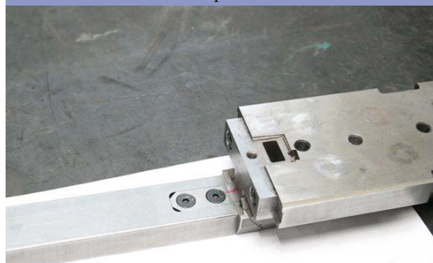
Obr. 5 Oprava deštruovaného dielu TN (všimnite si trhlinku v spodnej časti)
