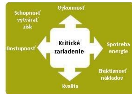
Obr. 2: GAS index (Global Asset Sustainability index) pozostáva zo štyroch hlavných zložiek: dostupnosť, výkon, kvalita, spotreba energie. Prvé tri zložky predstavujú Celkovú účinnosť zariadenia (OEE). Pridanou zložkou je energetická účinnosť
