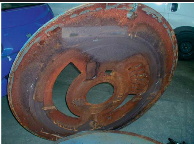
obr. 3 Čelo vývevy pred aplikáciou
