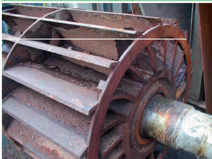
obr. 4 Renovácia vývevy s ARC 10 a ARC 858 - rotor vývevy pred aplikáciou
