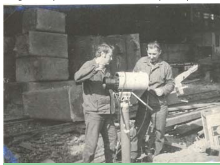
AGA 680 pri meraní teplotných profilov stripovaných ingotov – rok 1974.
