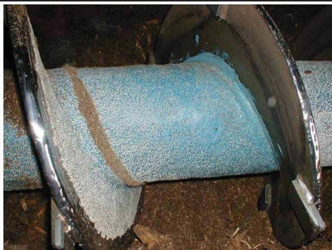
obr. 8 Renovácia závitovky vzhŕabávania paliva s ARC MX1 - detail
