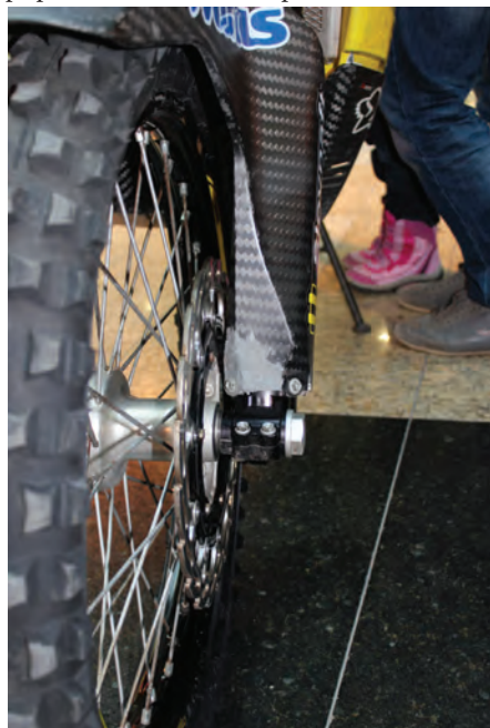
„Núdzová“ oprava poškodeného krytu vidlice motocykla KTM vydržala celé preteky (fotografia urobená po rely na propagačnej šou v Bratislave)
