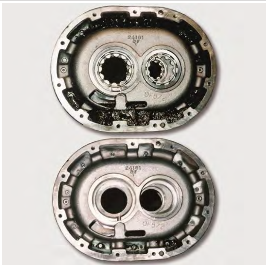
Obr. 3 Efekt očistenia vnútorných častí kompresora s použitím Klüber Summit Varnasolv
